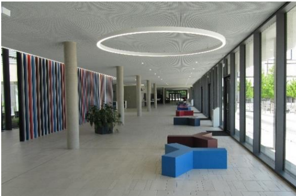
Abbildung 6: Hohe Verkehrsflächenanteile durch Fluraufweitungen und einbündige Erschließung
